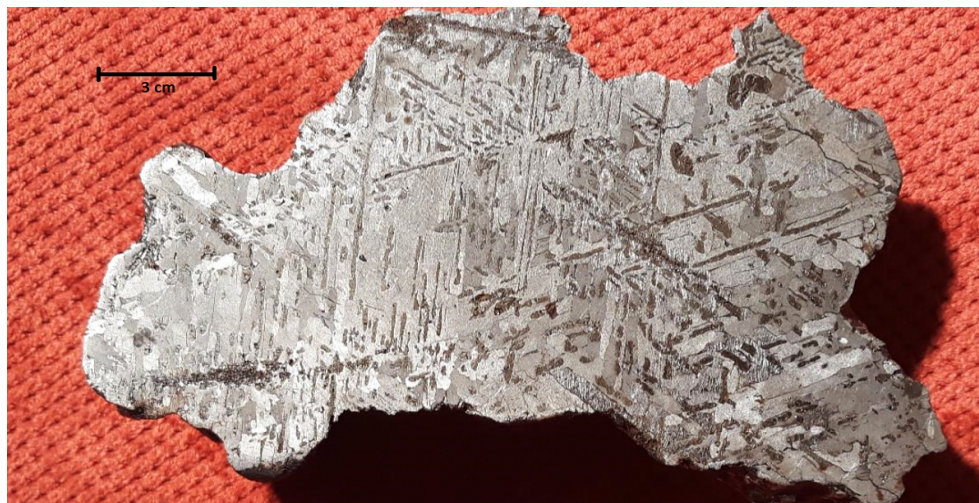
Ryc. 4. Zgląd metalograficzny meteorytu Morasko (fragment z kolekcji Michała Nebelskiego nazwany „Żelazko”) – widoczne figury Widmanstättena zbudowane z kamacytu (obszary metaliczne), taenitu (niewidoczne gołym okiem) oraz schreibersytu (ciemniejsze, metaliczne). Czarne „beleczki” to kryształy cohenitu.
