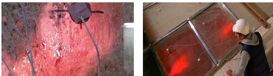
Rys. 8. Widok szkła ogniochronnego podczas badania. Po prawej widoczne zmatowienie części przeszklenia. Autor: ITB
