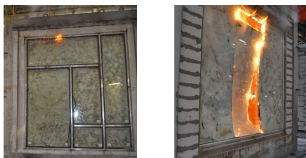
Rys. 1. Widok nienagrzewanej powierzchni elementu próbnego przeszklonej ściany działowej w momencie przekroczenia kryterium szczelności ogniowej. Autor: ITB
