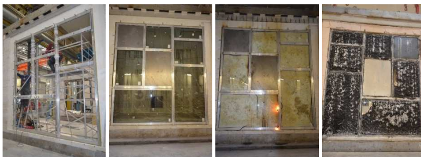
Rys. 5. Montaż elementu przeszklonego, widok przed, w trakcie i po badaniu na piecu o wymiarach 4,5m x 5m. Autor: ITB
