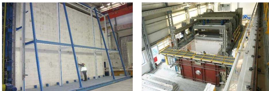
Rys. 4. Po lewej: piec pionowy o wymiarach 7 m x 10 m (wysokość x szerokość); po prawej: 3 komorowy piec do badań głównie elementów poziomych 4,3 m x 11,35 m. Autor: ITB
