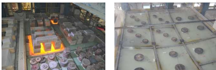
Rys. 6. Widok obciążonych grawitacyjnie poziomych elementów przeszklonych podczas badania odporności ogniowej. Autor: ITB
