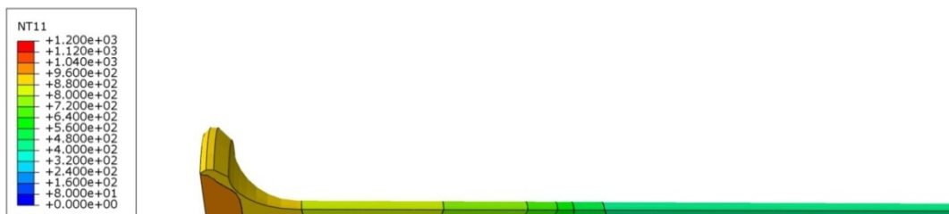
Rys. 10. Rozkład temperatury [K] wewnątrz zaworu wylotowego wykonanego ze stali H9S2, po rozgrzaniu silnika.
