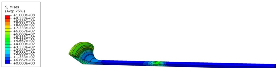
Rys. 9. Rozkład naprężeń zastępczych Hubera-Misesa wywołanych obciążeniem termo-mechanicznym wewnątrz zaworu wylotowego wykonanego ze stopu tytanu TiAl6V4, po rozgrzaniu silnika. Fig. 9. Huber-Mises substitute stress distribution induced by the thermo-mechanical load inside the exhaust valve made of TiAl6V4 titanium alloy, after the engine warm up.
