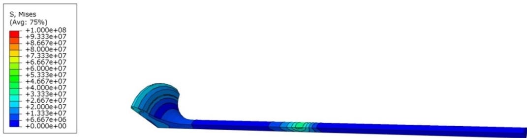
Rys. 8. Rozkład naprężeń zastępczych Hubera-Misesa wywołanych obciążeniem termo-mechanicznym wewnątrz zaworu wylotowego wykonanego z tytanu Grade 2, po rozgrzaniu silnika. Fig. 8. Huber-Mises substitute stress distribution induced by the thermo-mechanical load inside the exhaust valve made of Grade 2 titanium, after the engine warm up.
