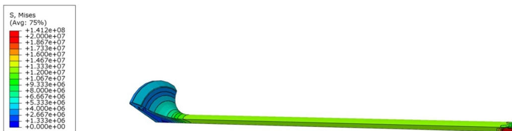
Rys. 6. Rozkład naprężeń zastępczych Hubera-Misesa wywołanych działaniem sprężyny zaworowej wewnątrz zaworu wylotowego wykonanego ze stopu tytanu TiAl6V4, dla zimnego silnika.
