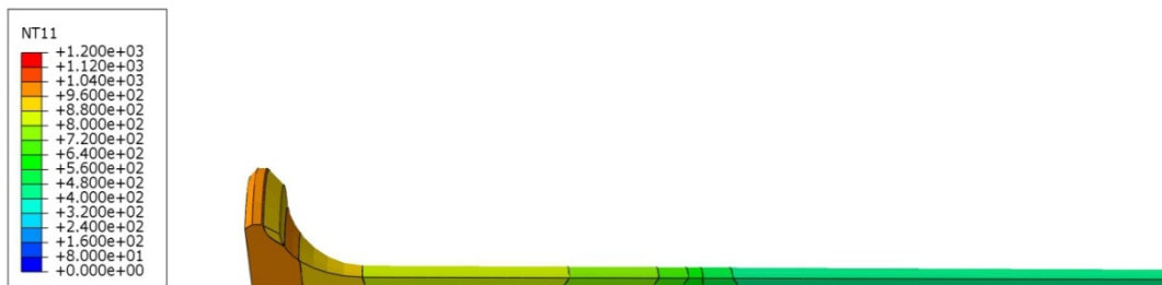
Rys. 11. Rozkład temperatury [K] wewnątrz zaworu wylotowego z tytanu Grade 2, po rozgrzaniu silnika.
