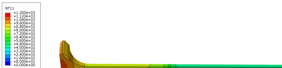
Rys. 12. Rozkład temperatury [K] wewnątrz zaworu wylotowego wykonanego ze stopu tytanu TiAl6V4, po rozgrzaniu silnika.
