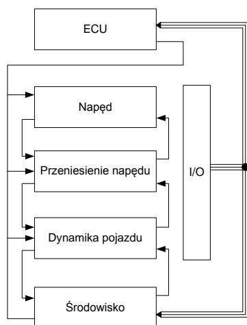
Rys 1. Schemat blokowy kompletnego modelu pojazdu elektrycznego [źródło: opracowanie własne]
