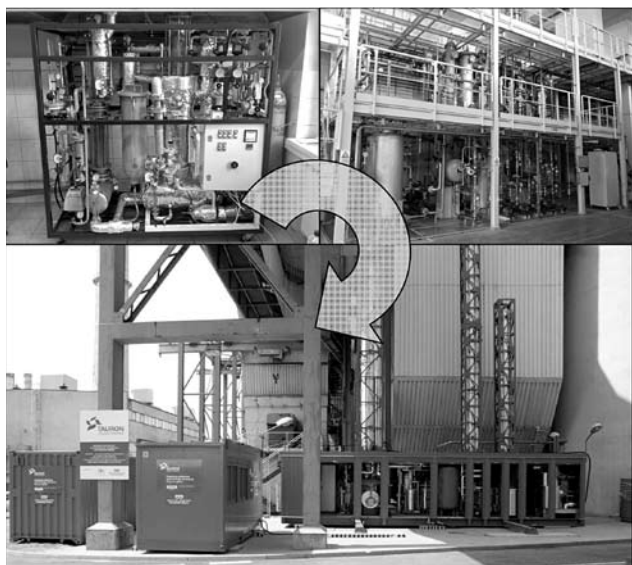
Rys. 1. Skalowanie procesu usuwania CO 2 . Instalacje wykorzystane do badań: laboratoryjna – 5 m 3 /h (lewa górna), półtechniczna – 20–100 m 3 /h (prawa górna), pilotowa – 200 m 3 /h (dolna)
