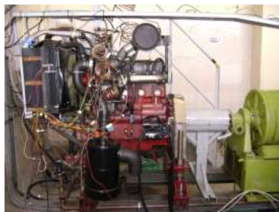
Rys. 11. Silnik testowy o zapłonie samoczynnym typu Z1505
