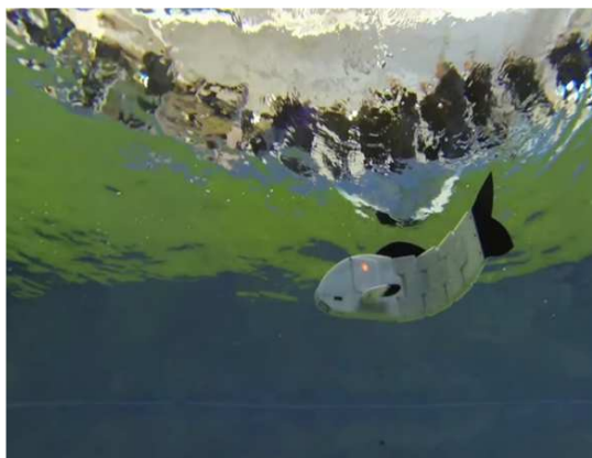
Rys. 3.10 Jedna z opracowanych w ramach projektu „Śledzik” koncepcji podwodnego pojazdu biomimetycznego.
