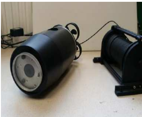
Rys. 3.15 Pojazd microROV Frog zbudowany przez firmę Forkos Sp. z o.o. w ramach projektu POIG.01.04.00-22-069/13 z zautomatyzowaną wciągarką kabloliny sterującej i specjalnym systemem TV do wymiarowania obiektów podwodnych.
