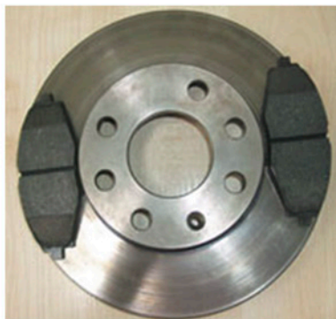
Rys. 4. Nakładka cierna i tarcza hamulcowa do samochodu Daewoo Lanos
