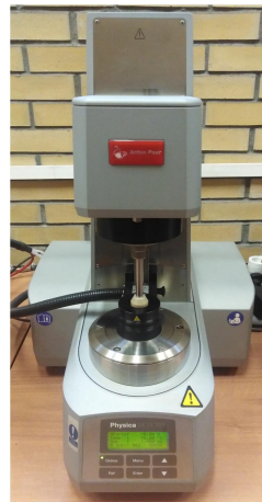
Rys. 2. Reometr dynamicznego ścinania DSR typu Physica MCR 101
