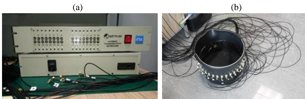
Rys. 2. Stanowisko badawcze: a) tomograf hybrydowy, b) reaktor z podłączonymi elektrodami
