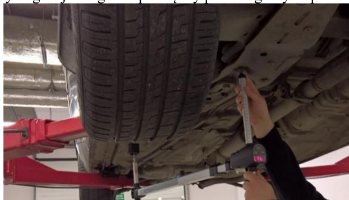
Rys. 2. Pomiary geometrii płyty podłogowej z wykorzystaniem urządzenia GYSMETER firmy GYS
