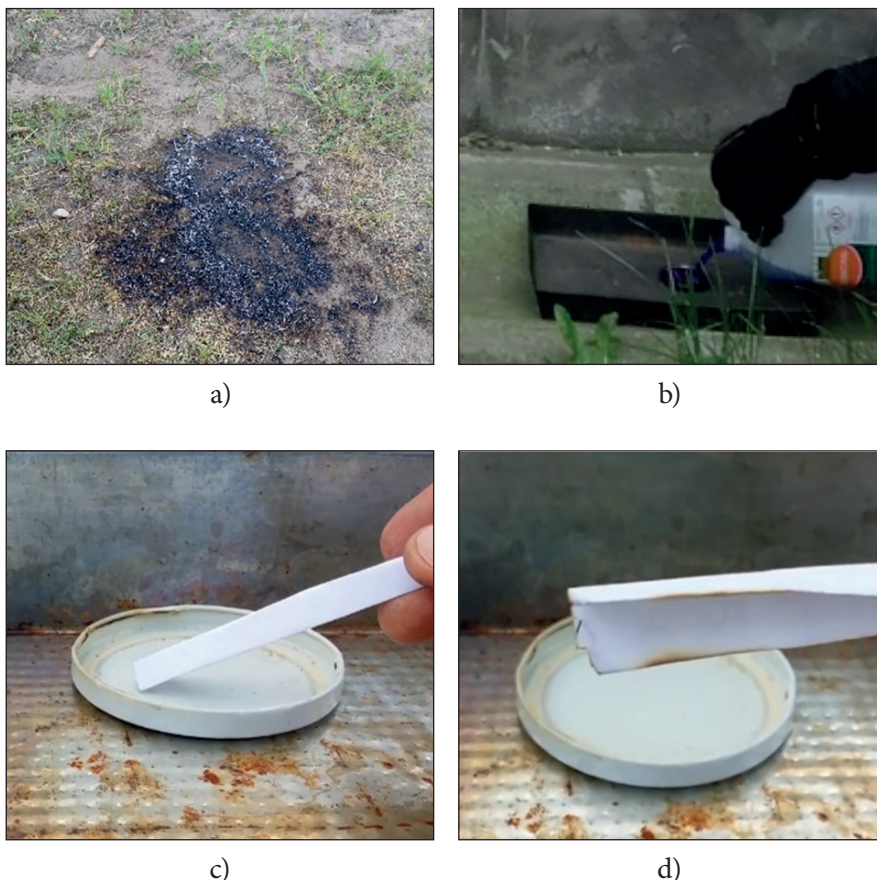
Rys. 5. Wypalanie się resztek alkoholu etylowego (denaturatu) – brak widocznych płomieni: na powierzchni terenu (a), w naczyniu (b) i (c), widoczne oznaki oddziaływania płomienia (d)
