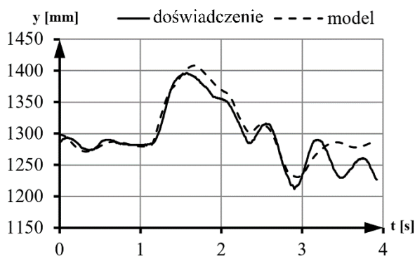
Rys. 7 Charakterystyka przemieszczenia punktu oznaczonego markerem A na kierunku pionowym w funkcji czasu
