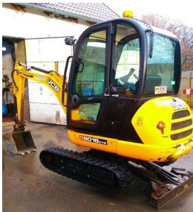
Rys. 3. Minikoparka firmy JCB model 8018 CTS, z której pochodziły badane gąsienice elastomerowe.
