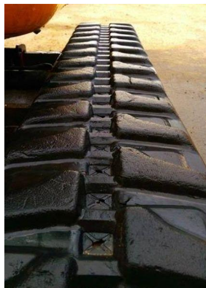
Rys. 7. Gąsienica elastomerowa Nr 2, próbka w stanie poeksploatacyjnym przez okres czasu wynoszący 1228 roboczogodzin. Na powierzchni widoczne liczne pęknięcia i uszkodzenia, krawędzie bieżnika znacznie zaokrąglone, a bieżnik porowaty.
