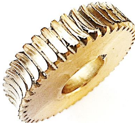
Rys. 1. Zniszczenie zębów ślimacznicy powstałe na skutek nadmiernego obciążenia.
