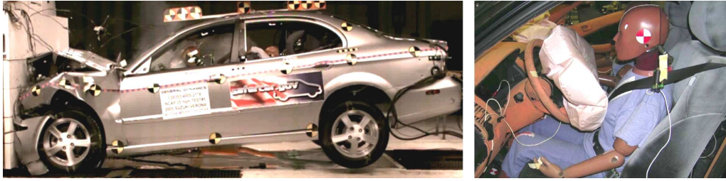
Rys.4. Zderzenie czołowe samochodu ze sztywną barierą [24]
