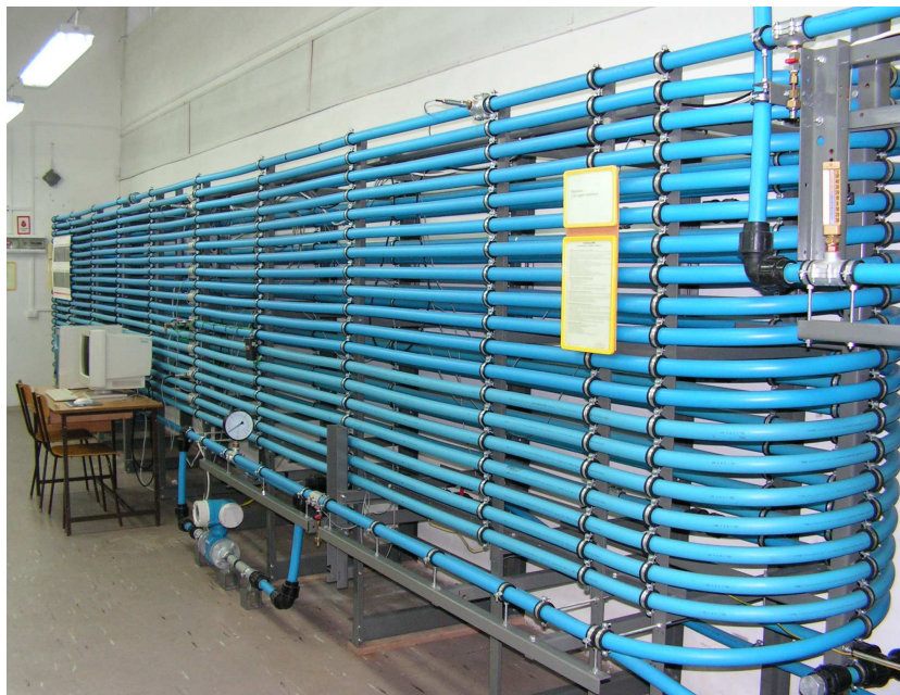
Rys. 5. Widok modelowego rurociągu
