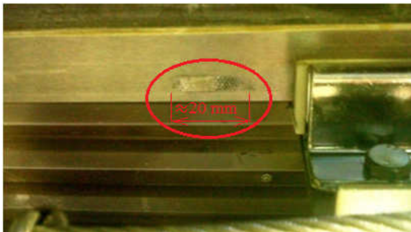
Rys. 10. Obszar uplastycznienia prowadnicy zaobserwowany w doświadczeniu
