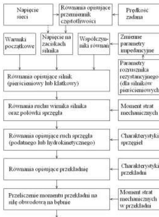
Rys. 2. Schemat blokowy modelu pojedynczego układu napędowego
