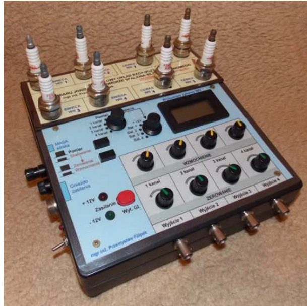
Rys. 3. Widok układu badawczego do pomiaru prądu jonizacji w czterech cylindrach
