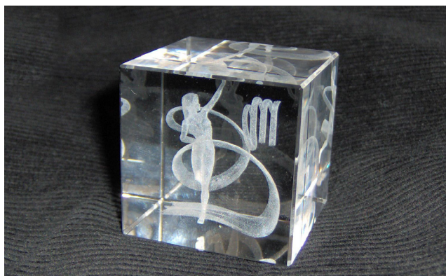
Rysunek 1 Przykładowy obiekt trójwymiarowy grawerowany laserem w przestrzeni szklanej bryły (wymiar: 40 x 40 x 40 mm; 15777 punktów struktury tworzących obiekt)
