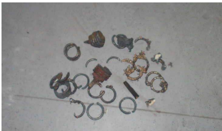
Rys. 11. Fragmenty sprężyn naciągowych
