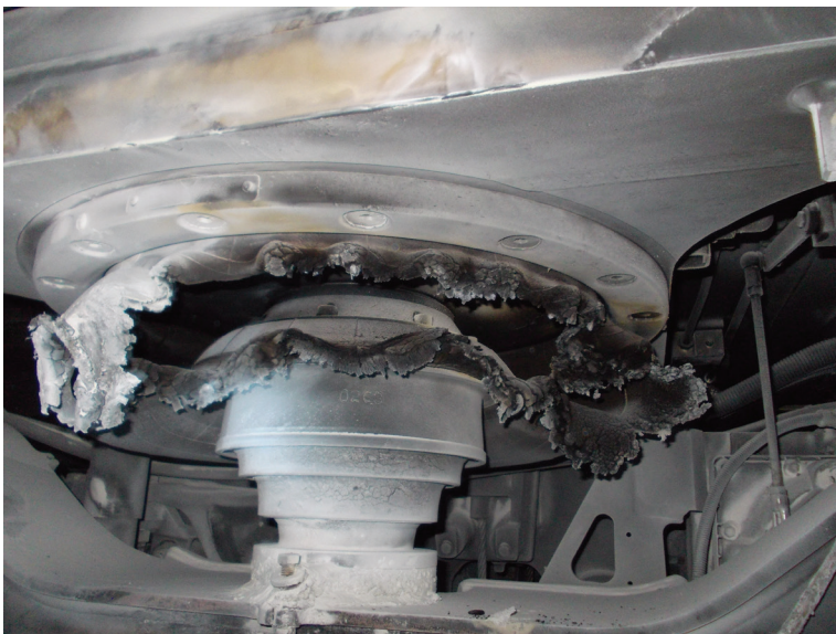
Rys. 6. Nadpalona poduszka powietrza układu zawieszenia II stopnia
