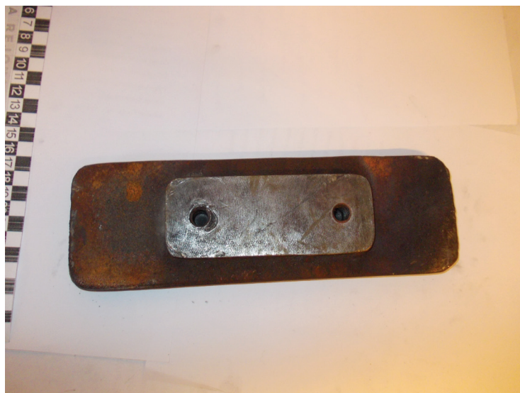
Rys. 12. Stan spodniej części ślizgu
