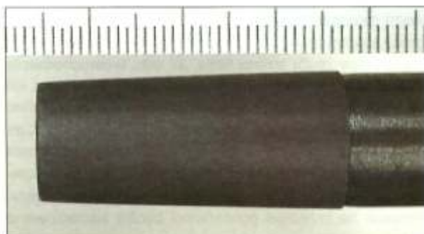
Ryc. 7. Widok wylotu lufy przerobionego karabinka pneumatycznego Fig. 7. Barrel outlet in converted air gun
