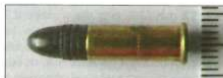
Ryc. 10. Widok boczny naboju sportowego bocznego zapłonu kal. 5,6 mm (.22) long rifle (pocisk pełny) Fig. 10. Side view of long rifle cartridge (full bullet) of cal. 22 long rifle rimfire
