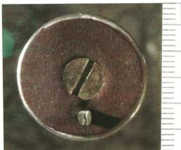
Ryc. 6. Widok powierzchni czołowej bijnika przerobionego karabinka pneumatycznego z zamontowanym grotem iglicznym Fig. 6. Striker front surface with fixed firing pin head of converted air gun
