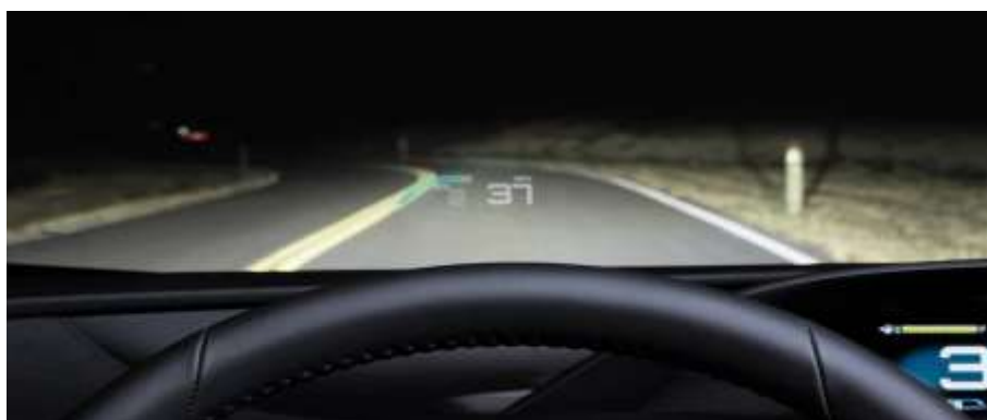
Rys. 1. Wyświetlacz HUD na bazie technologii SAR w Toyocie Prius
