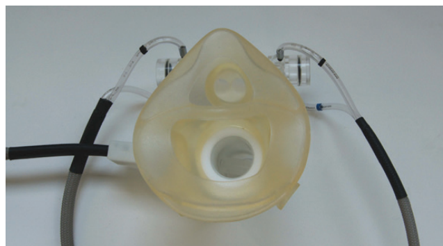
Ryc. 1. Urządzenie NOFA – jednoczęściowa silikonowa maska twarzowa (seria masek 7900 firmy Hans Rudolph Inc., USA) z przegrodą do przepływu powietrza drogą nosową i ustną. Przewodność martwa ustnych i nosowych głowic pneumatograficznych wynosiła odpowiednio 40 i 3,4 ml. Zakres mierzonych przepływów wynosił odpowiednio 18 i 2 litry/sekundę. Dokładność pomiaru wynosiła ponad 98% dla każdego z nich.
