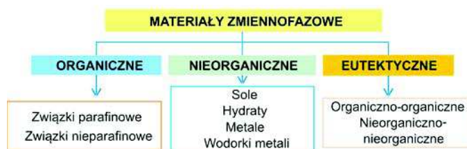
Rys. 2. Klasyfikacja związków zmiennofazowych [11]
