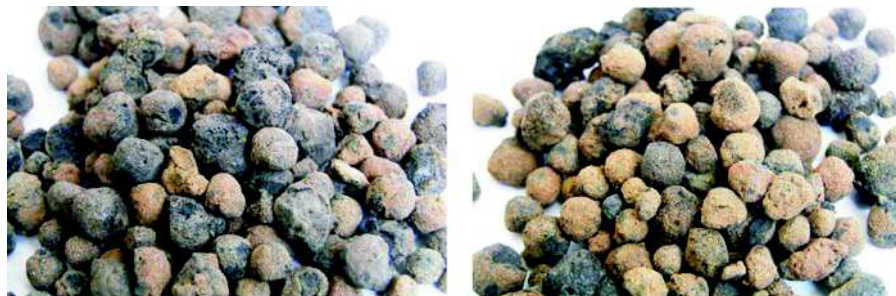
Rys. 5. Ziarna kruszywa A – niemodyfikowanego PCM, B – nasyczonego PCM
