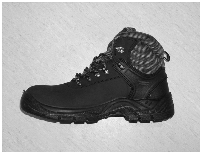
Rys. 1. Obuwiu ochronne (obuwiu A) zastosowane w badaniach – w okolicy palców podnosek kompozytowy [źródło własne]
