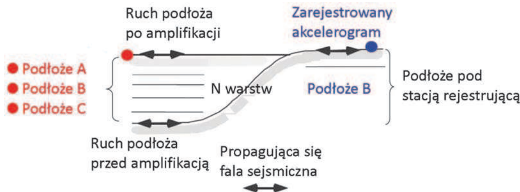
Rys. 1. Schemat pionowej propagacji drgań z głębi podłoża na jego powierzchnię
