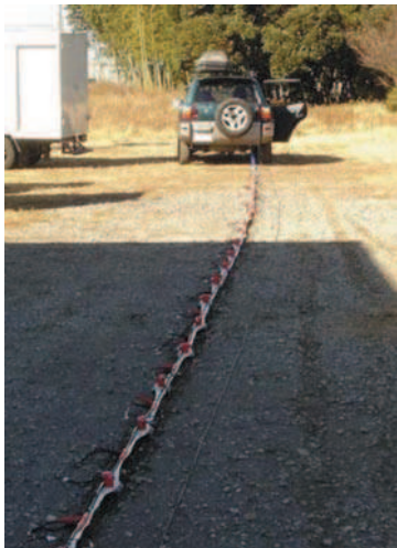
Rys. 3. Taśmowa konstrukcja strimera sejsmicznego LS-1 produkcji Geostuff [24]
