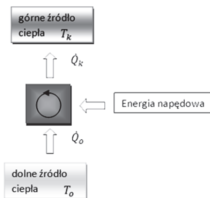
Rys. 1. Zasada transportu energii w pompie ciepła
