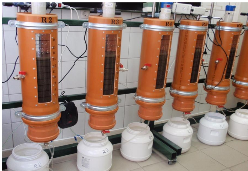
Rys. 1. Model doświadczalny komór SBR
