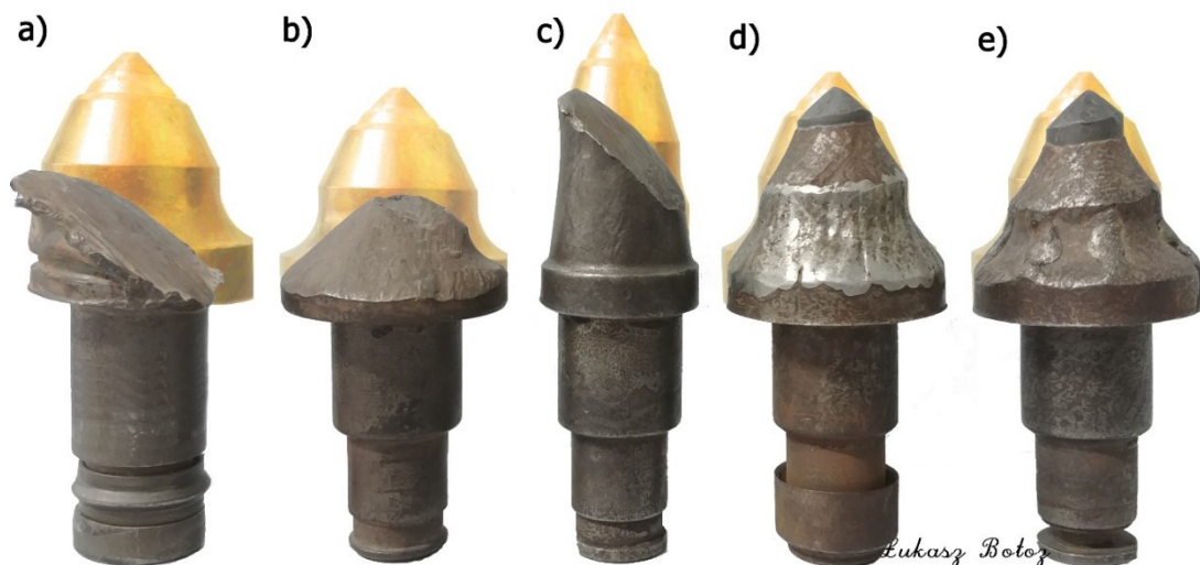
Rys. 11.2 Przykładowe formy zużycia noży styczno-obrotowych: a i c - niesymetryczne, b, d, e - symetryczne
