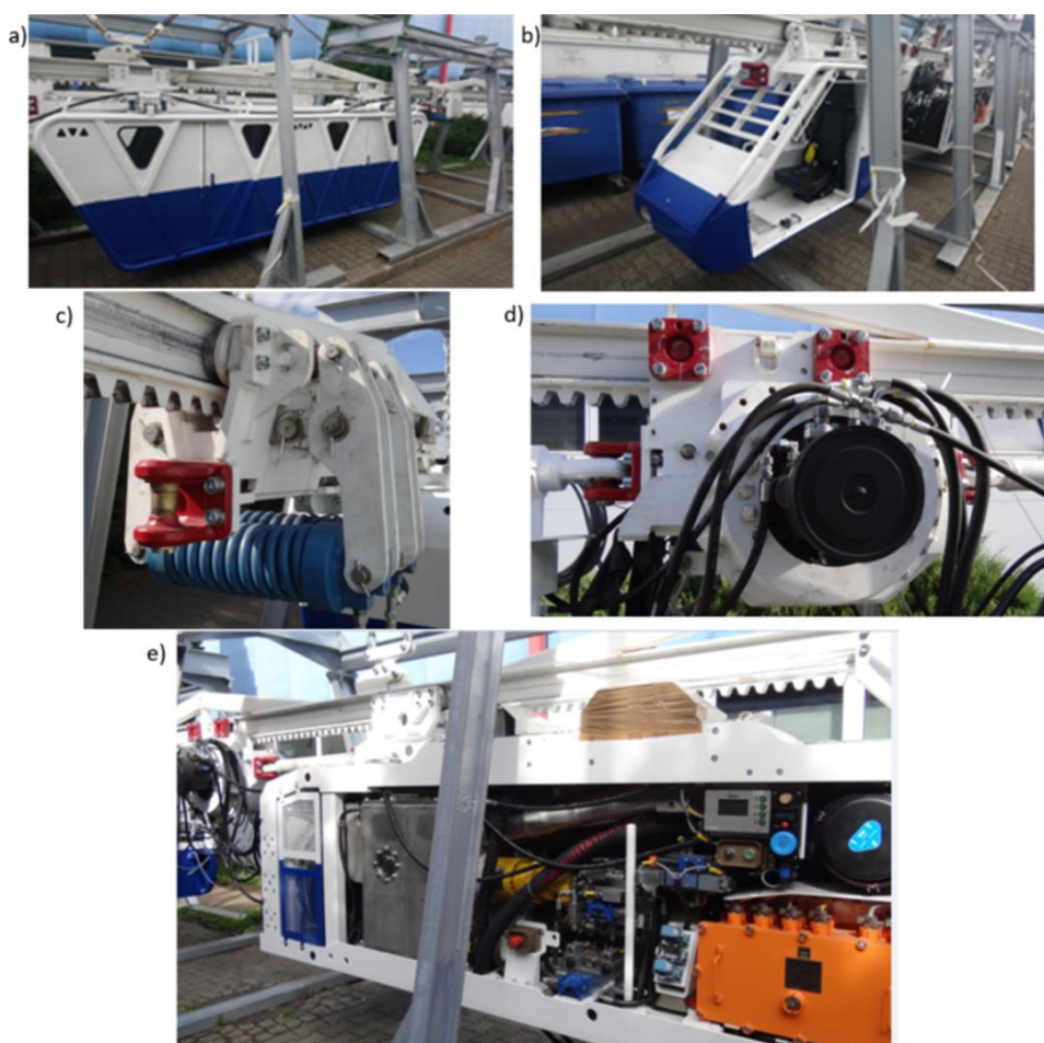
Rys. 2. Podzespoły kolejki podwieszanej na torze badawczym; a) kabina do przewozu osób, b) kabina operatora, c) wózek hamulcowy, d) napęd zębaty z zabudowanym hamulcem wielopłytkowym, e) część maszynowa [7]
