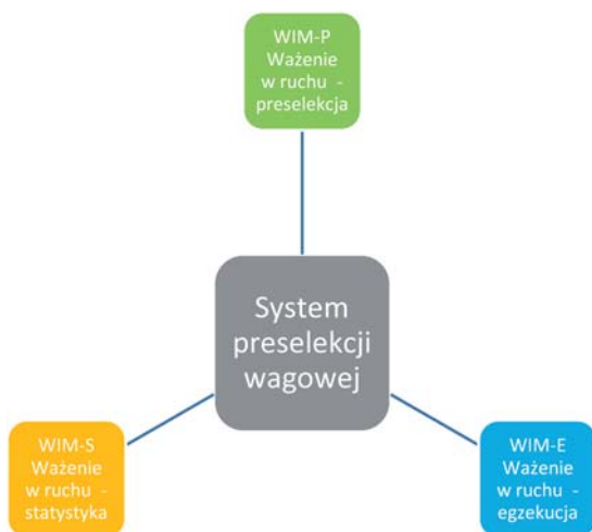
Rys. 2. Składowe systemu preselekcji wagowej (źródło: opracowanie własne)
