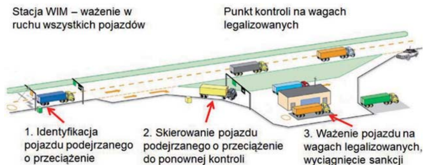
Rys. 8. Schemat działania systemu preselekcji wagowej (źródło: Wpływ pojazdów przeciążonych na trwałość nawierzchni, D. Ryś i in.)
