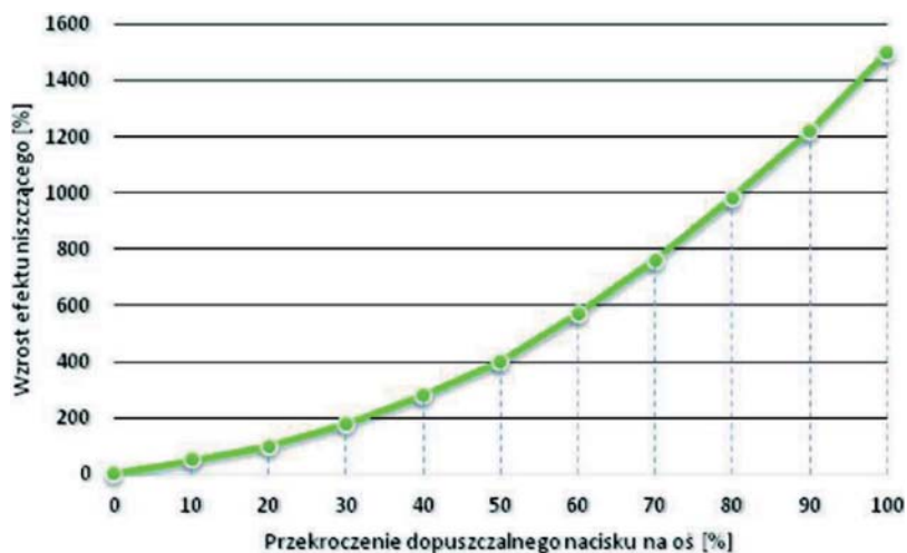
Rys. 3. Wzrost efektu niszczącego pojazdu przeciążonego (źródło: Inteligentny system preselekcji wagowej pojazdów – Degradacja Dróg T. Dzieńis, M. Karkowski)
