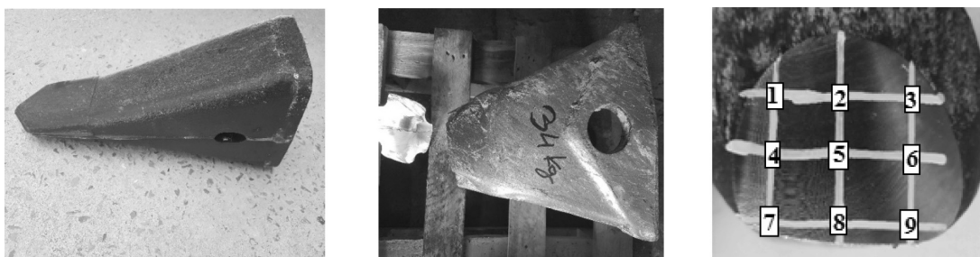
Fig. 3. Teeth of the ripper, cut-off point, and hardness measurement points Rys. 3. Ząb zrywaka, miejsce odcięcia zęba i punkty pomiaru twardości
