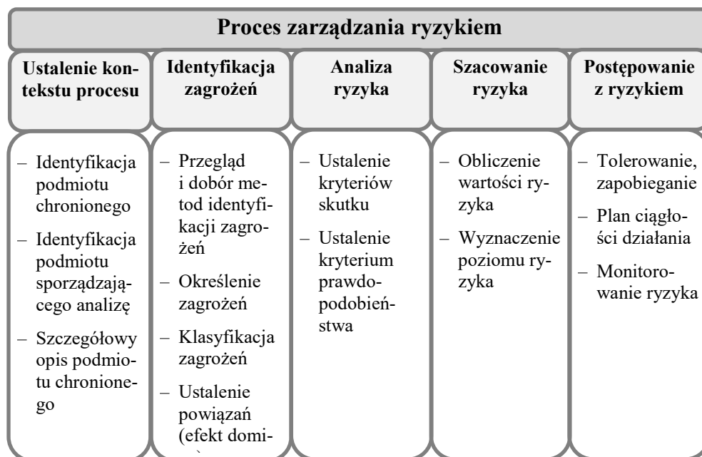
Rys. 1. Schemat procesu zarządzania ryzykiem (Kosieradzka, Zawila-Niedźwiecki, 2016, s. 185)
