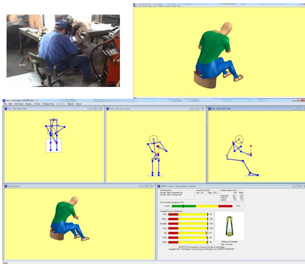
Rys. 7. Przykładowe widoki ekranu aplikacji 3DSSPP z analizą obciążeń na stanowisku spawania w pozycji siedzącej. Fot. G. Dahlke; widoki aplikacji 3DSSPP [15] – licencja: Politechnika Poznańska
