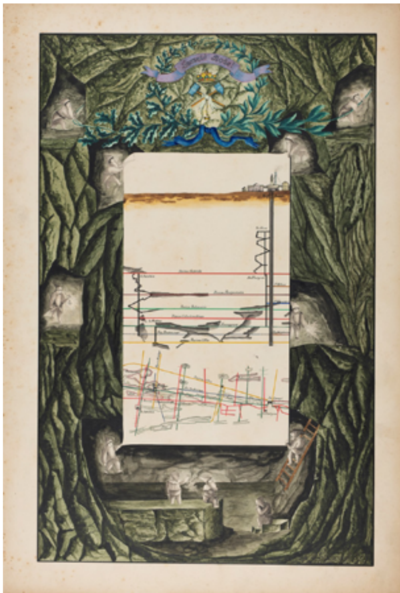
Ilustracja 2. Rzut poziomy i pionowy szybiku i poprzeczni Miszkego oraz mapa fragmentu kopalni z obramieniem imitującym wnętrze komory z gnomami, rys. A. Ślusarczyk, oprawa R. Jaboda, Bochnia, 30 maja 1897
