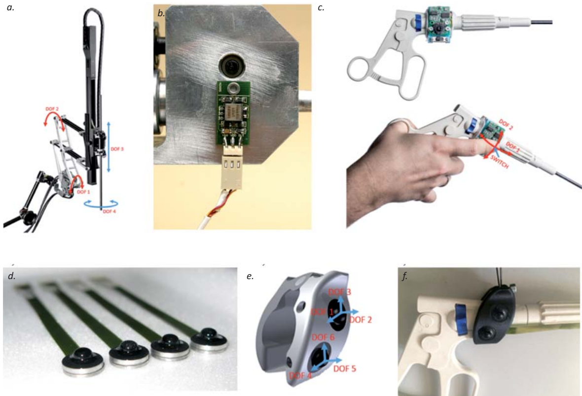
Rys. 8. Prototypy miniaturowych zadajników dedykowanych dla robotów toru wizyjnego: robot Pelikan z zaznaczonymi stopniami swobody (a), zadajnik – wersja urządzenia w oparciu o czujniki żyroskopowe (b), z zastosowaniem manipulatora punktowego (trackpoint) (c), oraz czujnika siły 3D wykonanego w technologii MEM's (projekt INCITE) wykorzystywanego jako mikrodzwojstka (d-f)
