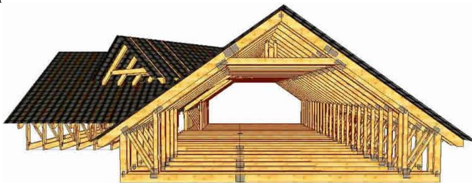
Rys. 7. Attykowy dach budynku jednorodzinnego z więzarów prefabrykowanych, dający całkowicie wolną przestrzeń na poddaszu [7]
