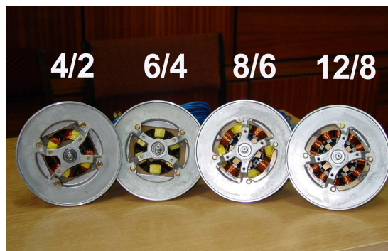
Rys.11. Widok wykonanych modeli maszyn reaktancyjnych przełączalnych
