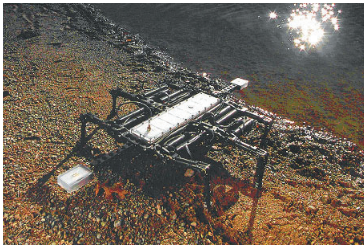
Rys. 2. Robo-krab podczas działań przeciwminowych (widoczne: korpus, odnóża kroczone, rozłożone ramiona z kompasem i inklinometrem, cylindryczne ogniwa zasilające).
