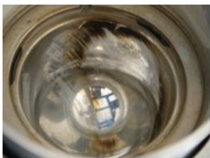
Rys. 9. Powierzchnia robocza panewki CoCrMo po teście tarciovo-zużyciowym na symulatorze SBT-01- przy zakresie kąta obrotu ( -20^\circ ; +20^\circ )
