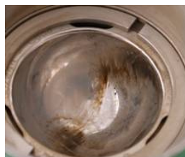
Rys. 10. Powierzchnia robocza panewki CoCrMo po teście tarciovo-zużyciowym na symulatorze SBT-01- przy zakresie kąta obrotu ( -10^\circ ; +30^\circ )
