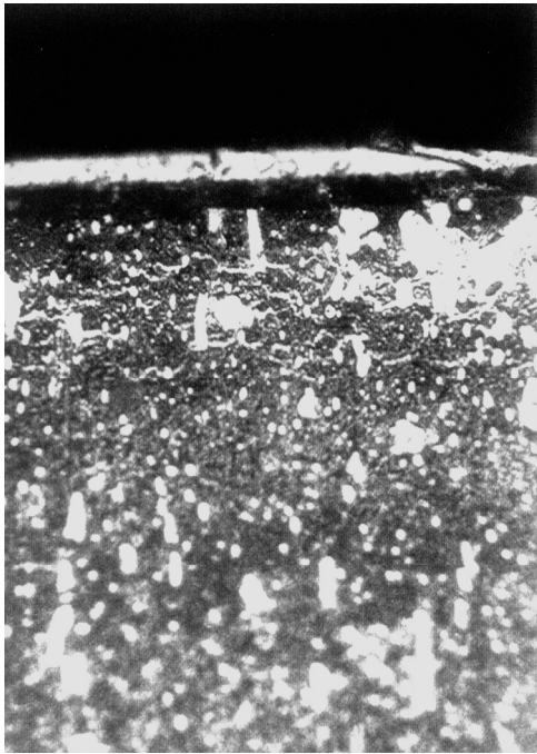
Rys. 8. Struktura próbki ze stali NC11LV zahartowanej z temperatury 1020 °C i nagniatanej z siłą 400 N, po azotowaniu jonowym w temperaturze 480 °C. Pow. 500 x
