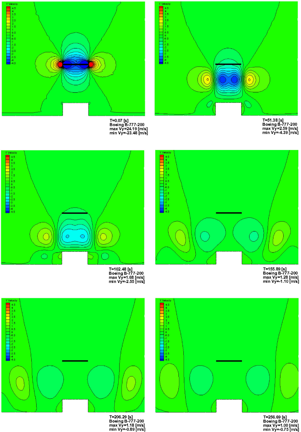
Rys. 4. Przebieg zmian w czasie rozkładu prędkości pionowej w wirze powstałym za samolotem pasażerskim [opracowanie własne, 2016]
