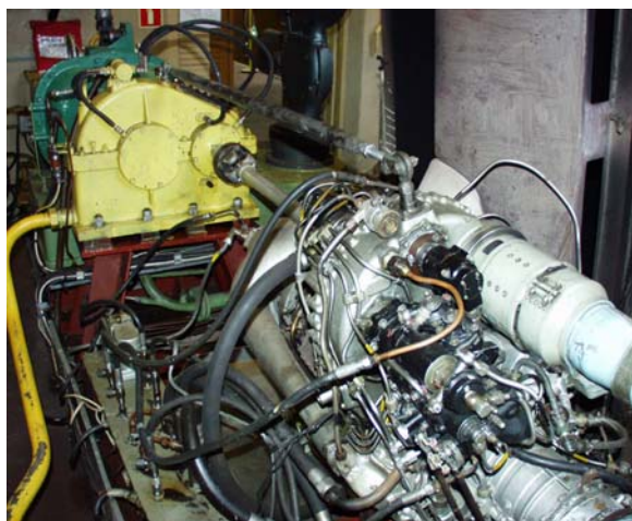
Rys. 2. Stanowisko laboratoryjne z turbinowym silnikiem spalinowym GTD-350
