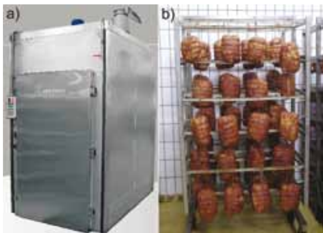
Rys. 1. Komora wędzarnicza jednowózkowa: a) widok ogólny; b) wózek wypełniony wsadem.
