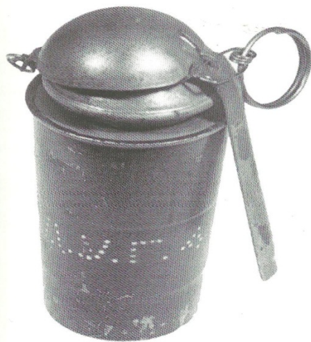
Zaczepty granat uderzeniowy ET-40 zwany „Filipinką”, z zapalnikiem bezwładnikowym o wybuchu natychmiastowym, konstrukcji Edwarda Tymoszaka, z czerwca 1940 r.
