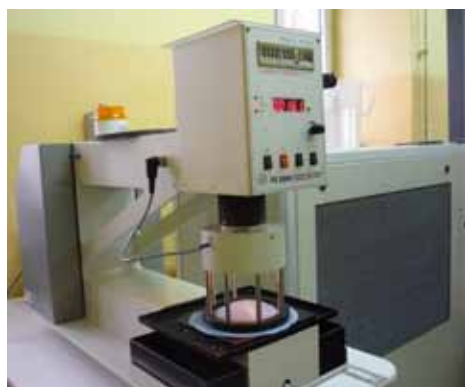
Rysunek 3 Stanowisko do badania wodoszczelności w ITB MORATEX
