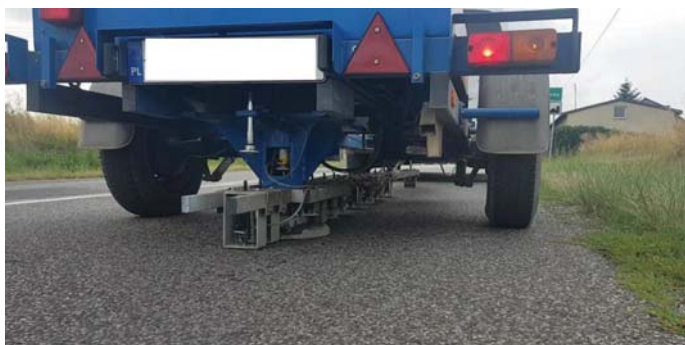
Fot. 2. Zdjęcie aparatu FWD na badanym odcinku drogi (materiały własne)
